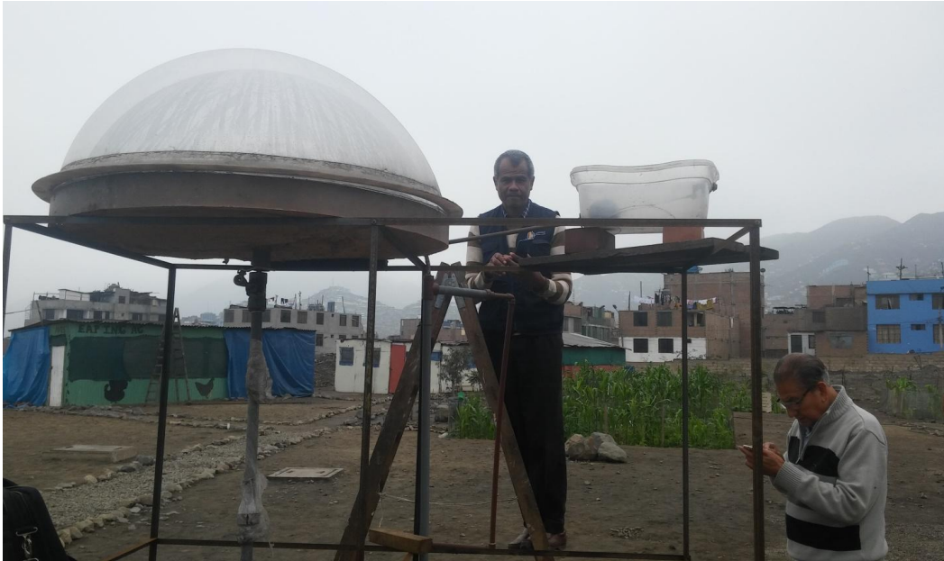
Figura 1: Desalinizador parabólico de vacío (DPV)
